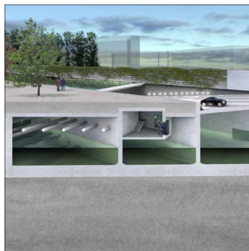
Abb. 3.24 Nutzung der Lufträume der Rotterdamer Museumpark-Tiefgarage als Regenrückhalteraum [Gemeente Rotterdam]
