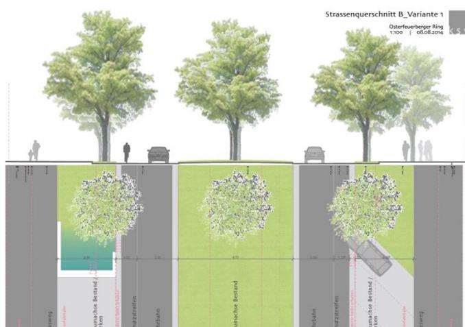
**Abbildung 23: Neu geplanter Straßenquerschnitt zur Umgestaltung des Osterfeuerberger Rings- Breiter Grünstreifen zwischen den Fahrbahnen, begrünte Nebenanlagen, markante Baumstruktur und Versickerung von Niederschlagswasser**
